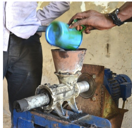
Presse à charbon conçue et fabriquée par l'Iset de Rosso
