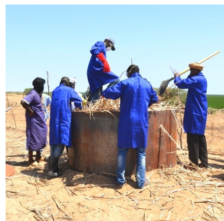
Enfournement du Typha dans un carbonisateur à Bouhajra (PND)
